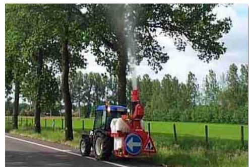
Figuur 14: Sproeien van biociden met een boomnevelspuit
